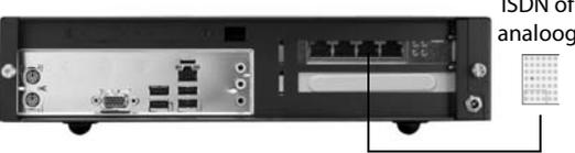
**2** Uw centrale beschikt eventueel over een ISDN- of analoge kaart. Sluit met een ISDN- of telefoonkabel een aansluiting van de ISDN- of analoge kaart aan op de NTBA van uw ISDN-aansluiting resp. op uw telefoon-aansluiting.
